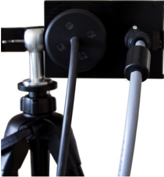
Abb. 4: Messeinheit mit Verbindungsschlauch und Steuerungskabel
