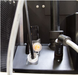
Abb. 3: Kondensatabeidemodul zwischen Gasweg und O 2 Sensor montiert
