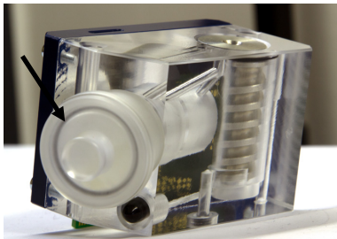
Abb. 4: Kondensatabscheidemodul mit Kieselgel-Perlenbehälter
