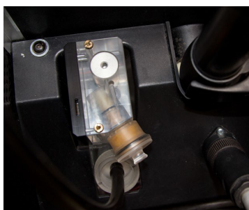
Fig. 7: Filtro a graniglia montato sulla sede moduli CO e O 2
