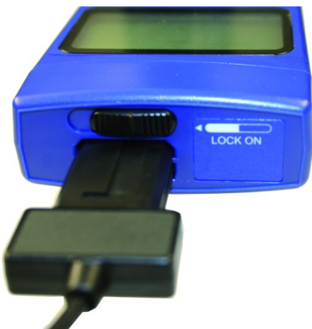
Fig. 16: Pour insérer le connecteur du capteur dans l'appareil, placer l'interrupteur coulissant dans la position droite
