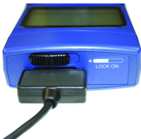
Afb. 29: Voor het vergrendelen van de sensorstekker schuifschakelaar in de stand naar links
