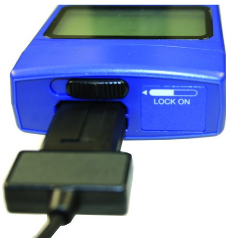
Abb. 4: Sensorstecker wird eingesteckt, Schiebeschalter in rechter Position
