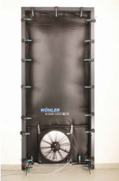
Abb. 7: Gebläseeinheit und Plane komplett montiert.
