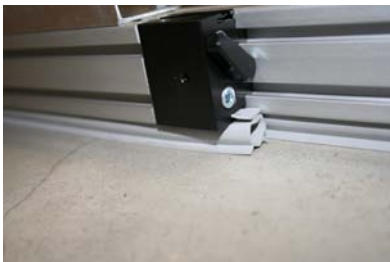
Abb. 6: Arretierhebel steht schräg: Schiene ist arretiert.
