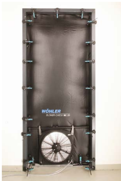
Fig. 23: Unité à soufflerie et feuille d'étanchéité.
