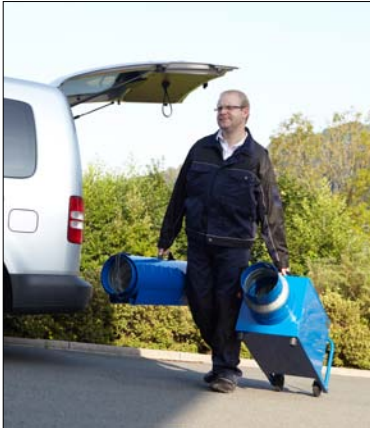
Abb. 1: Transport der Staubfalle und der Schlauchpatrone mit zwei Schläuchen.
