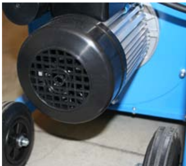
Abb. 4: Motor mit Belüftungsschlitzen
