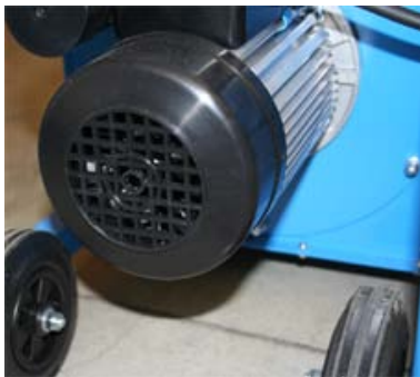
Afb. 28: Motor met ventilatierooster
