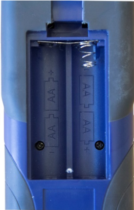
Fig. 21: Vano pile aperto
