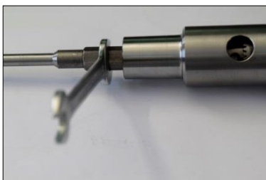
Fig. 23: Desserrer l'axe (40 cm)
