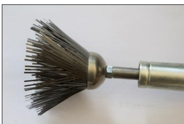
Fig. 17: Brosse cloche vissée sur l'axe
