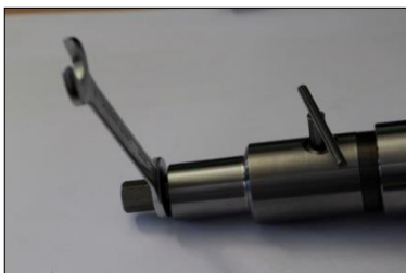
Fig. 24: Desserrez l'axe (13 cm) avec la clé de mandrin.
