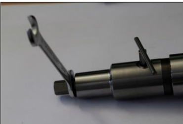
Abb. 12: Lösen der Spindel (13 cm) mit dem Bohrfutterschlüssel
